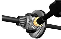
Figura 5: Modelo 3D de un carro diferencial.
